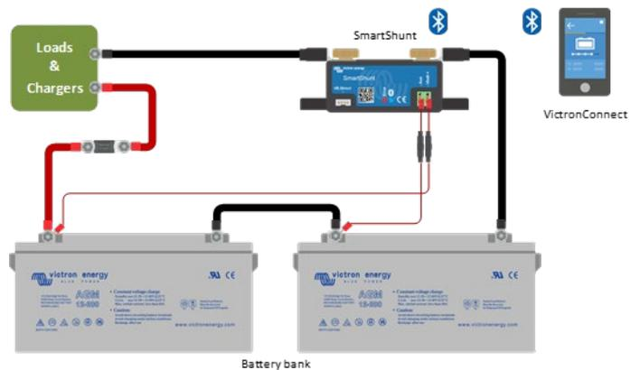
Messen des Mittelpunkts der Batteriebank
