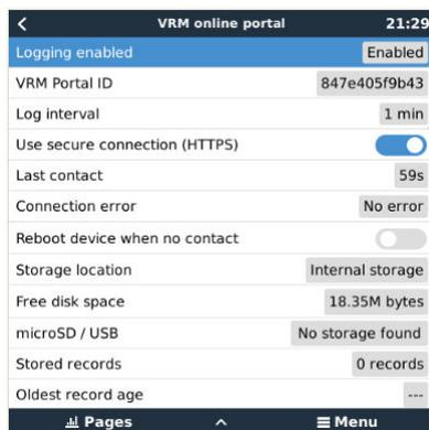
Die Übertragung der Datenprotokolle wurde so konzipiert, dass sie auch bei schlechten Internetverbindungen funktioniert. Leitungen mit bis zu 70 % permanentem Paketverlust reichen immer noch aus, um die Daten herauszuholen, auch wenn sie in einigen Fällen verzögert werden.
